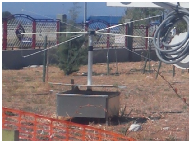
Εικ.3 Η κεραία Codalema στο χώρο του ΕΑΠ στην Πάτρα (μία από τις έξι).
